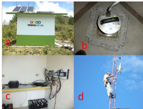
Figura 2.1. Estación Sísmica Viejo Volcán a) Caseta sísmica, b) Sensor Sísmico De Banda Ancha Guralp, c) Digitalizador y d) Antena de Telemetría (fotos cedidas por Montalvo, A., 2018)
