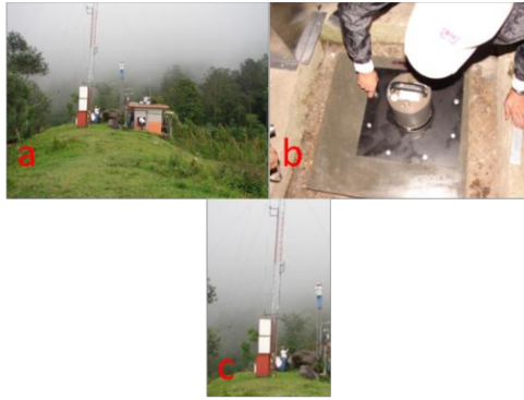
Figura 2.4. Estación Sísmica Chiquihuites a) Caseta sísmica, b) Sensor Sísmico De Banda Ancha Guralp y c) antena de telemetría Digital (fotos cedidas por Montalvo, A., 2018).
