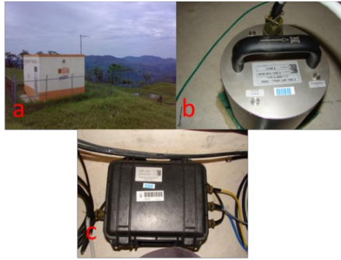
Figura 2.2. Estación Sísmica Francisco León a) Caseta sísmica, b) Sensor Sísmico De Banda Ancha Guralp y c) Digitalizador (fotos cedidas por Montalvo, A., 2018).
