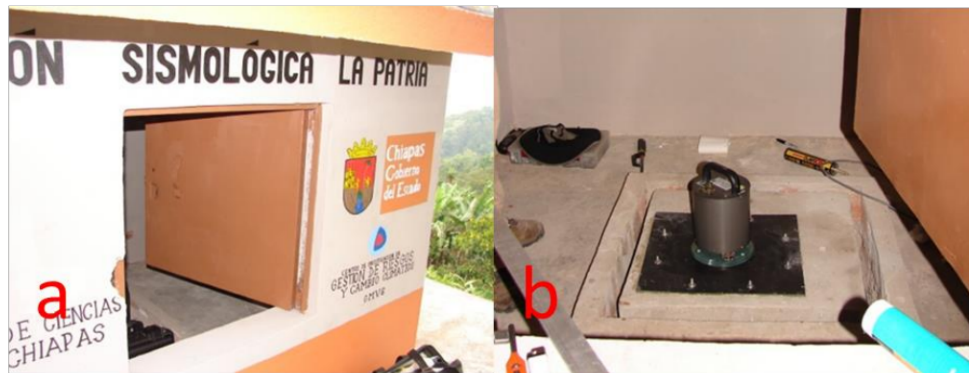
Figura 2.5. Estación Sísmica La Patria a) Caseta sísmica, b) Sensor Sísmico De Banda Ancha Guralp (fotos cedidas por Montalvo, A., 2018).
